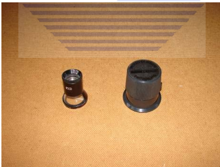
Fotografie č. 2 – Lupa pro měření trhlin
