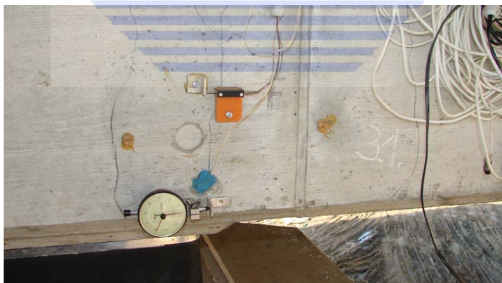
Fotografie č. 6 - Komplexní měření trhlin - kontinuální měření na konstrukci – potenciometrický snímač, číselníkový úchylkoměr, dále body pro měření změn šířky trhliny deformetrem a teploměrem
